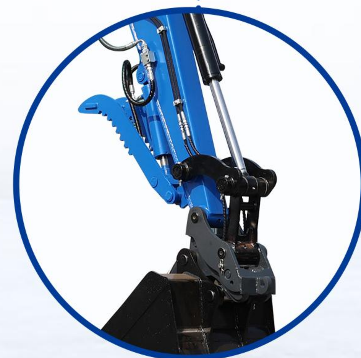
Wird standardmäßig mit Daumenclip und Schnellwechsel geliefert
