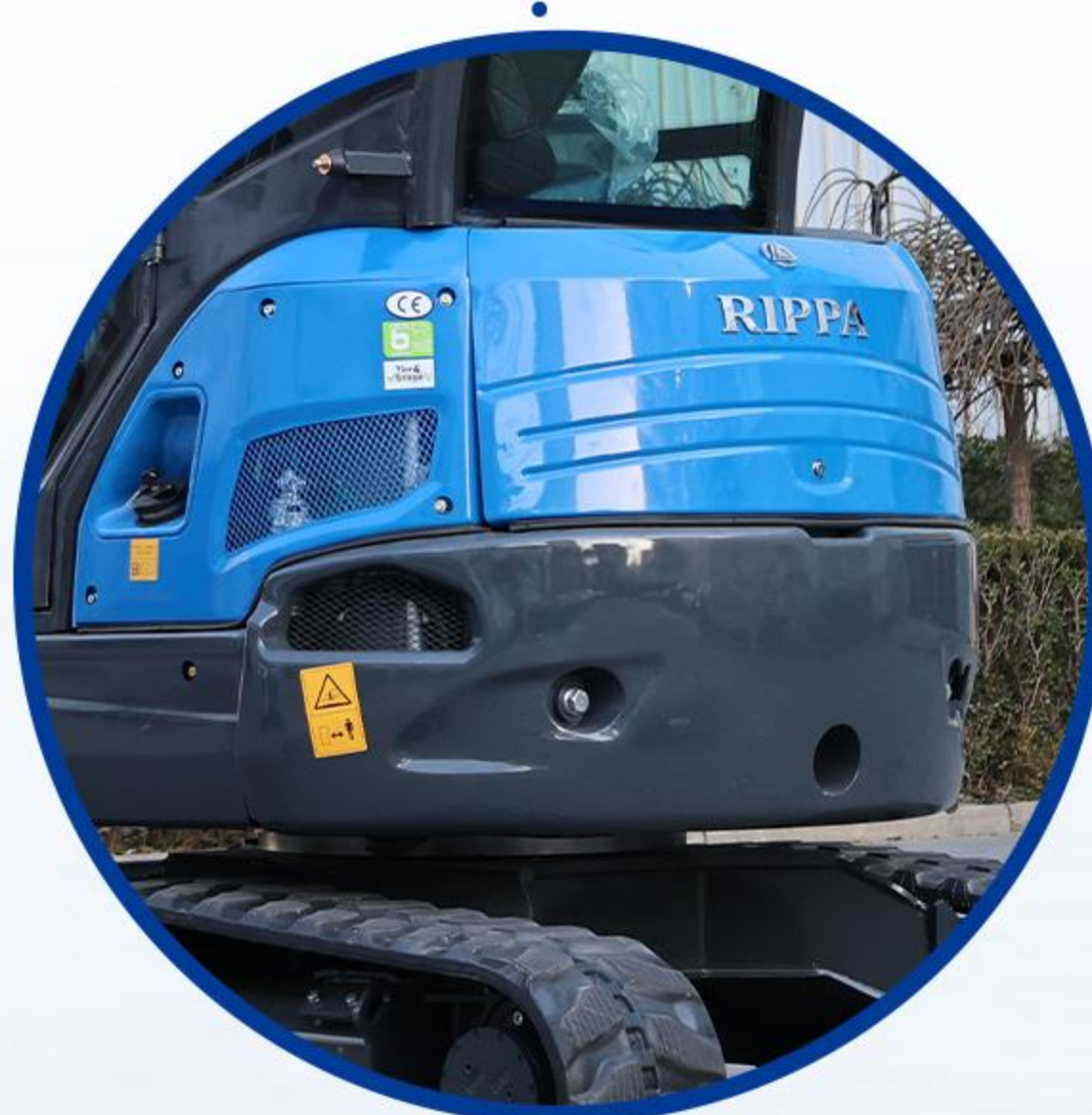
Contrepoids - Poids réel : 3.2 tonnes
