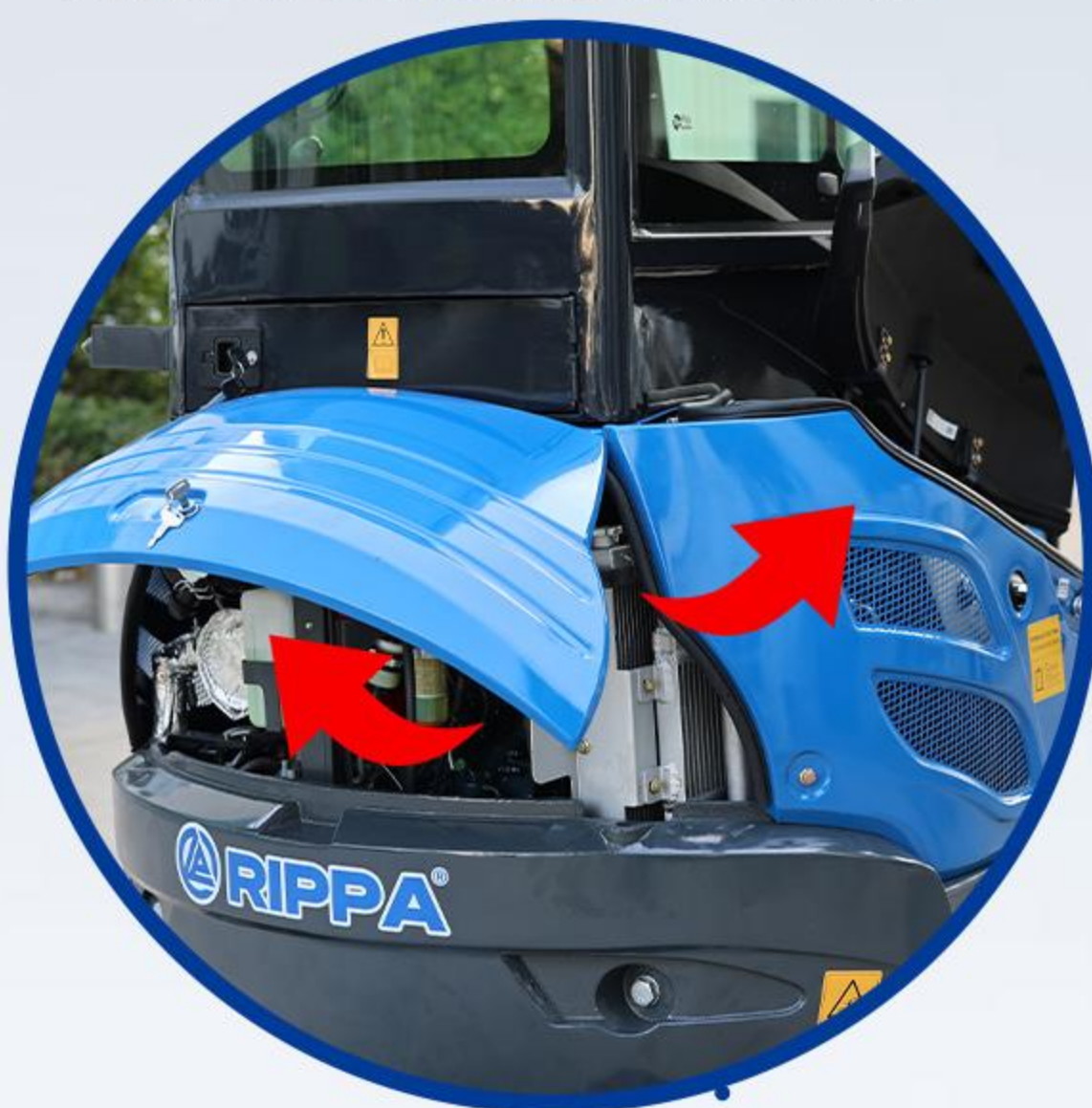
Deux ports d'inspection entièrement ouverts
