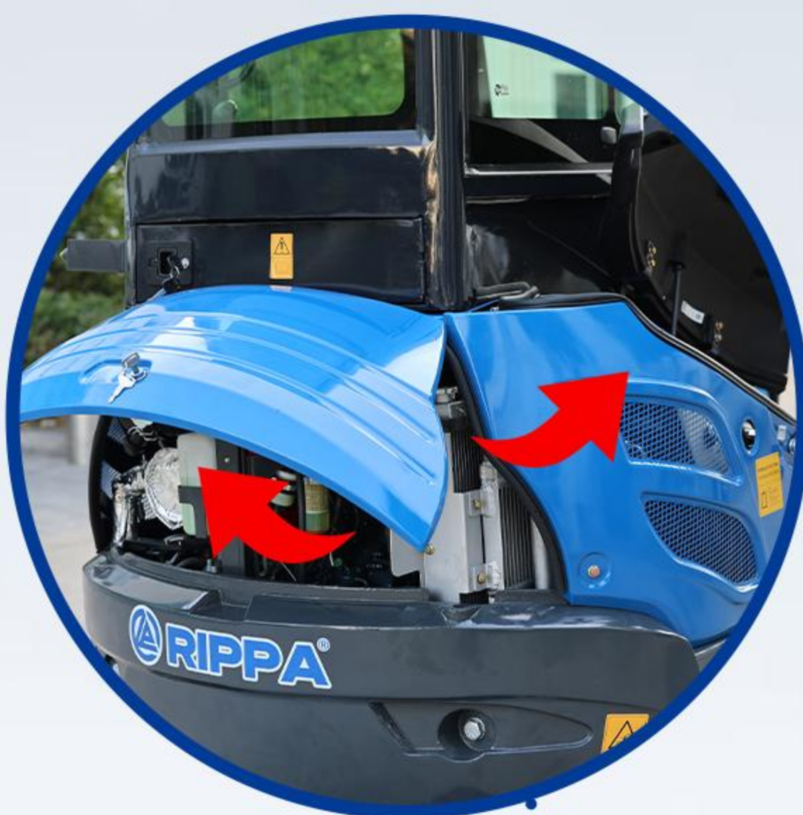
Dos puertos de inspección completamente abiertos
