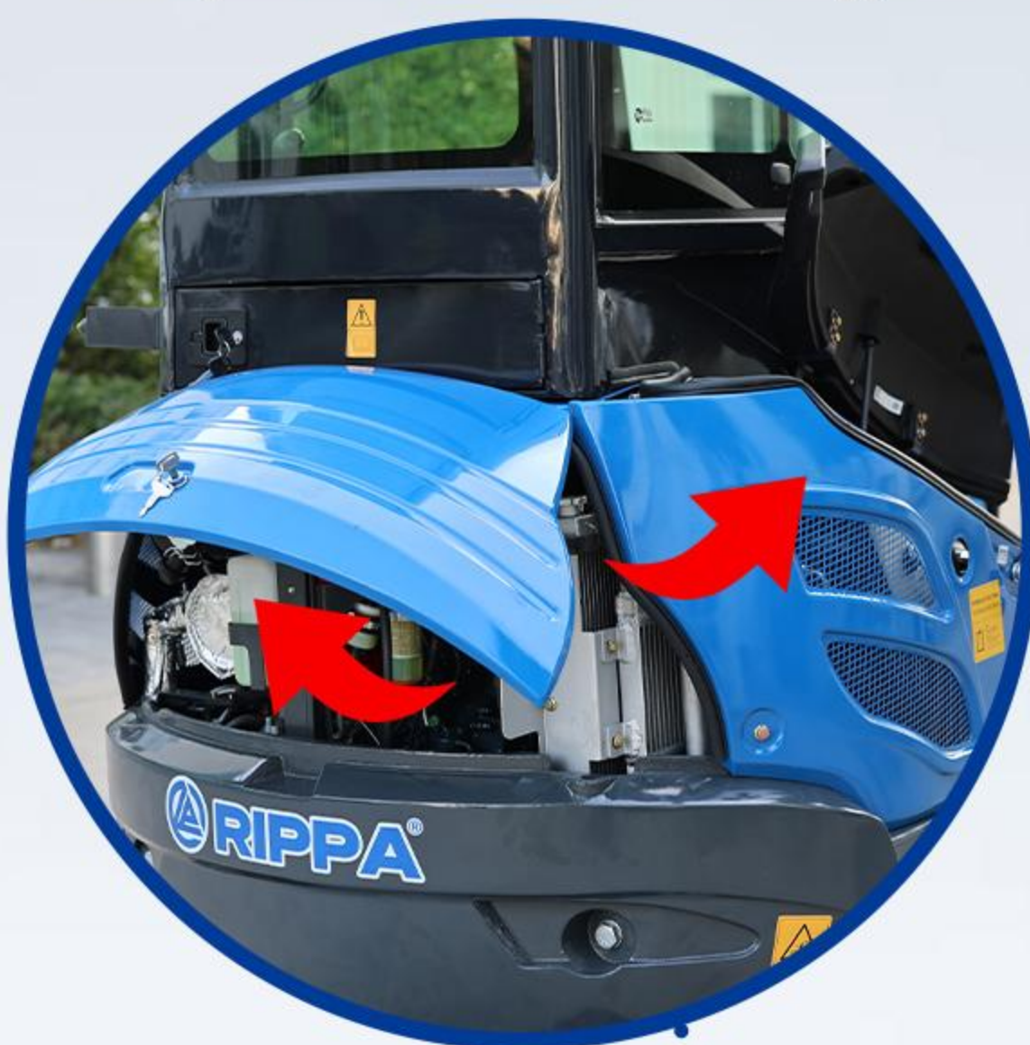
Zwei vollständig geöffnete Inspektionsöffnungen
