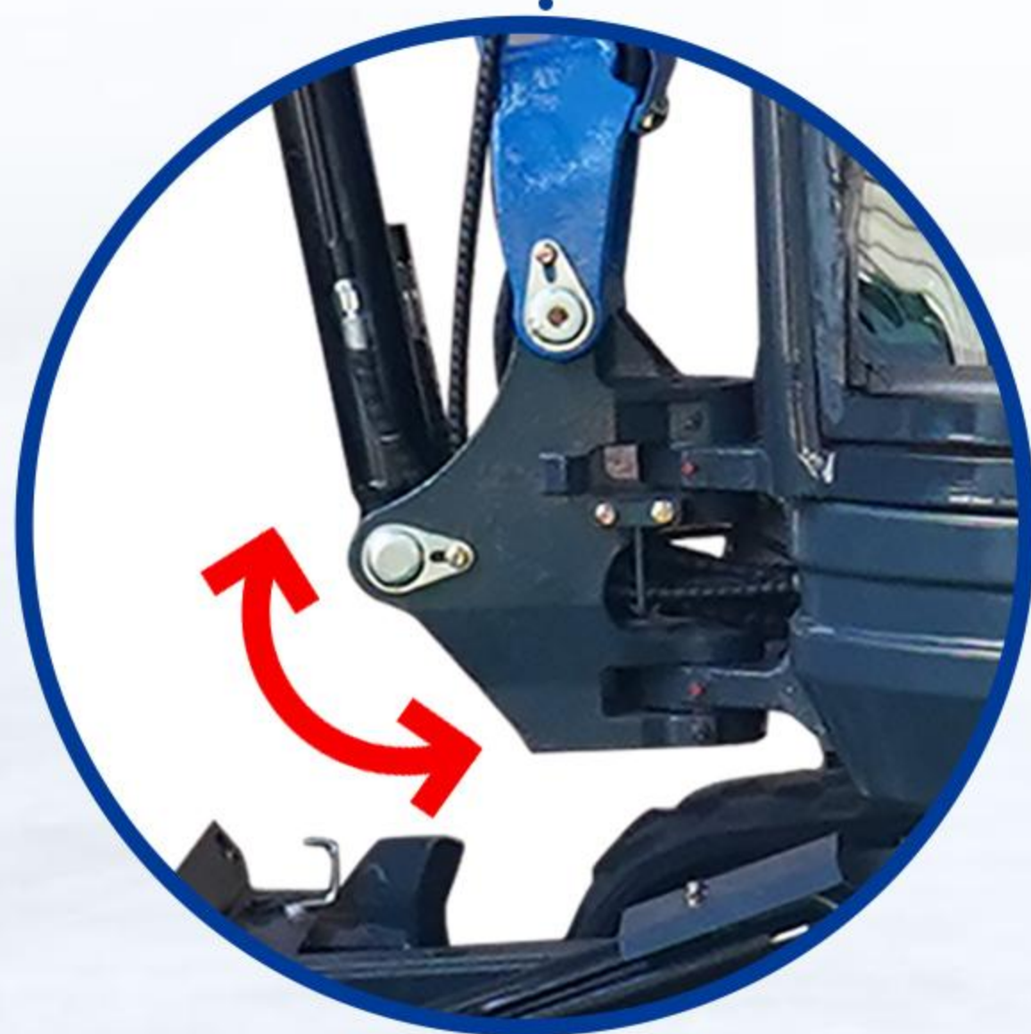
Einteilige Gussauslegerhalterung + großer seitlicher Schwenkarm
