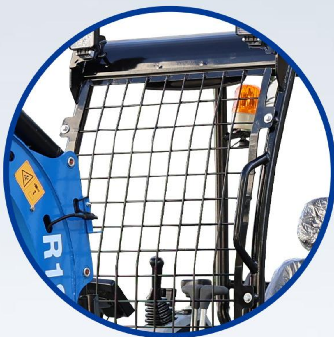
Protection supérieure et frontale contre les chutes d'objets
