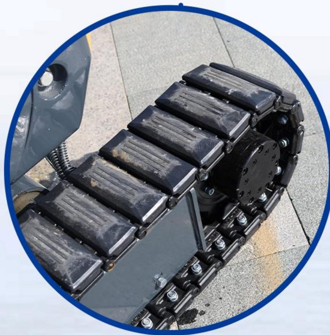
Chenilles en acier + blocs en caoutchouc pour la durabilité et la protection du sol
