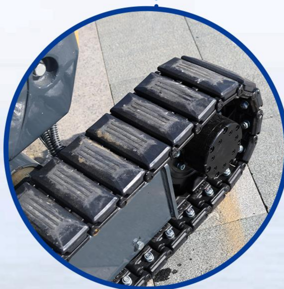
Orugas de acero + bloques de goma para mayor durabilidad y protección del suelo.
