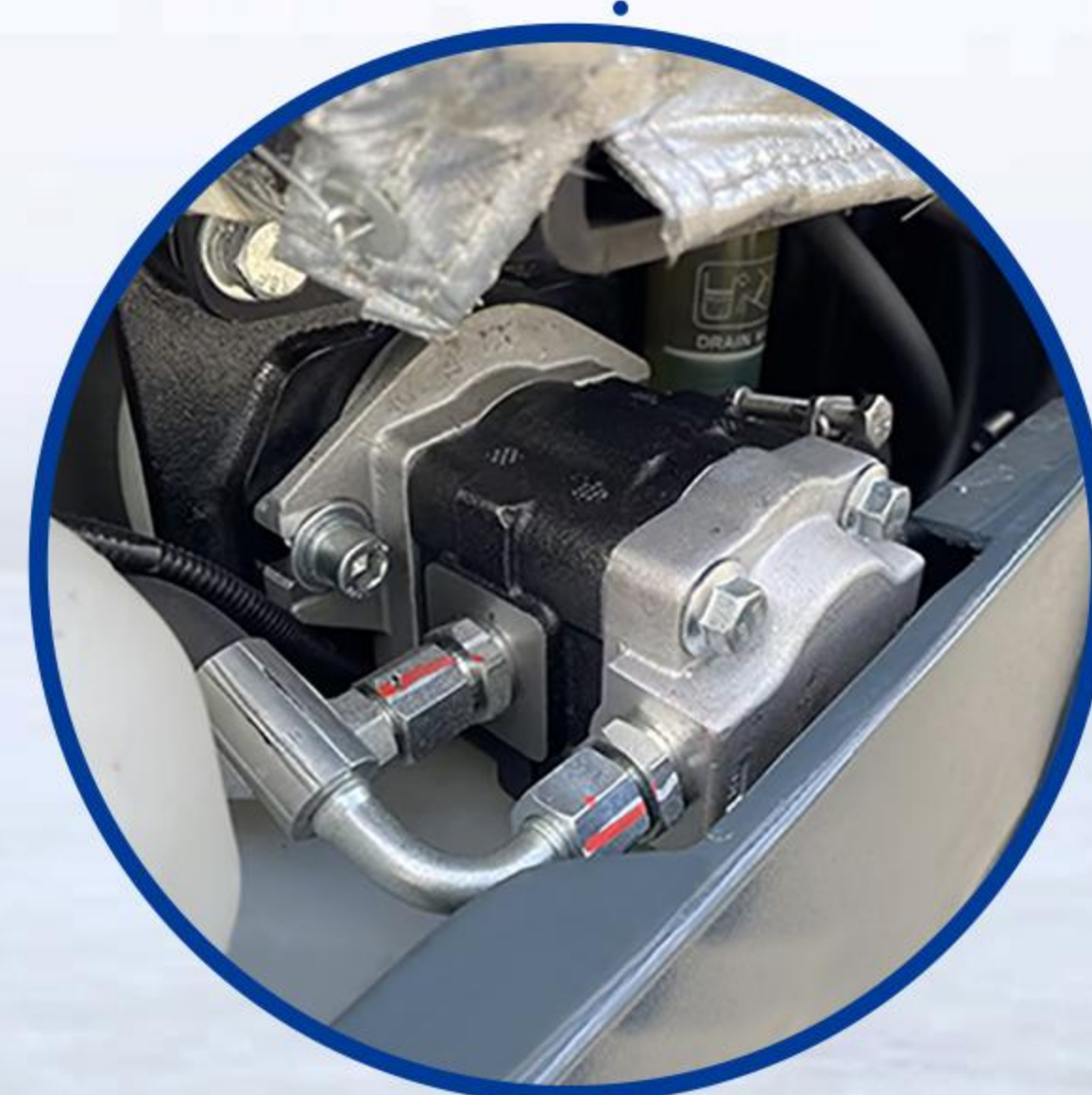
Configuración combinada de 3 bombas
