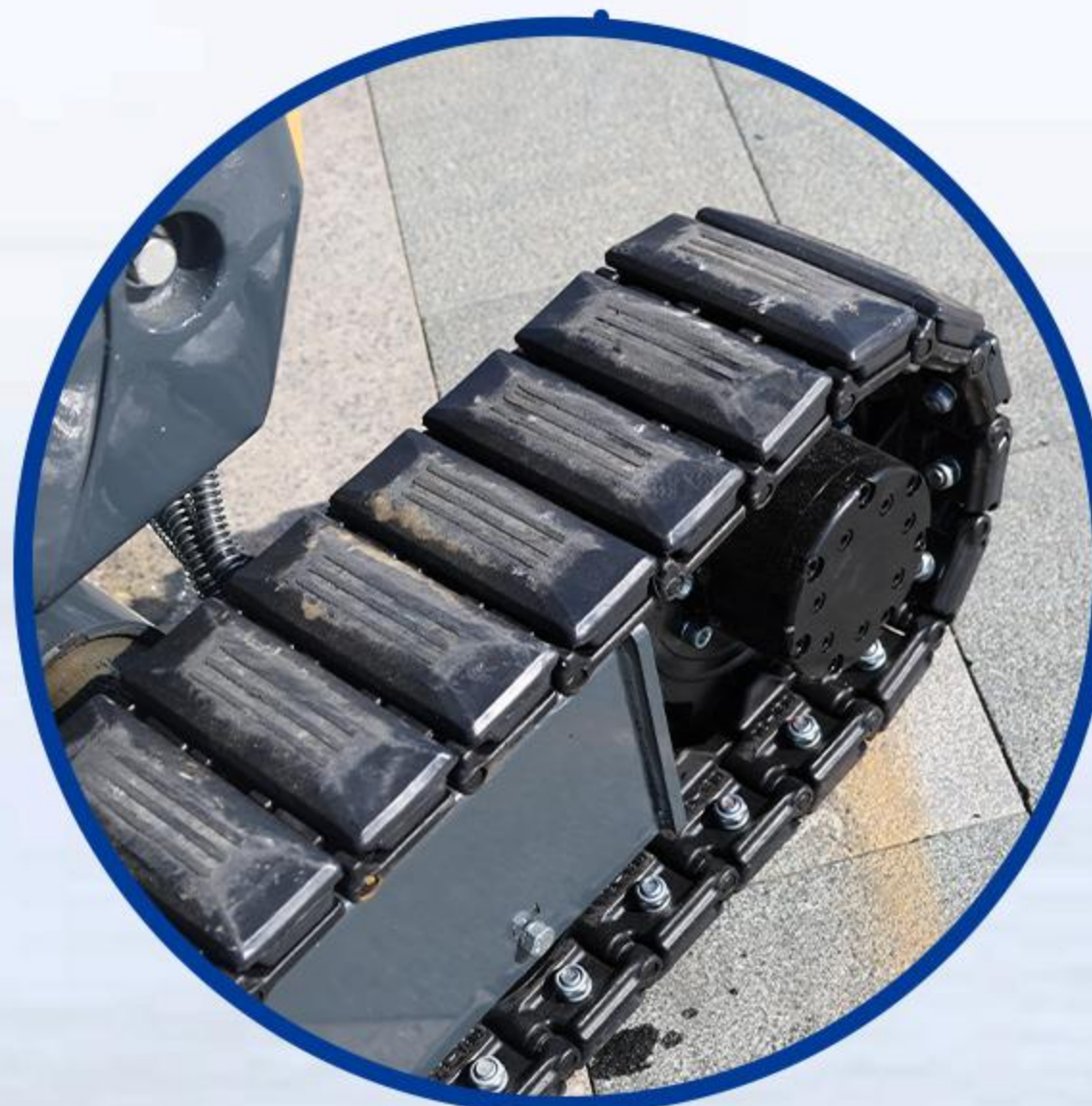
Stahlketten + Gummiblöcke für Langlebigkeit und Bodenschutz
