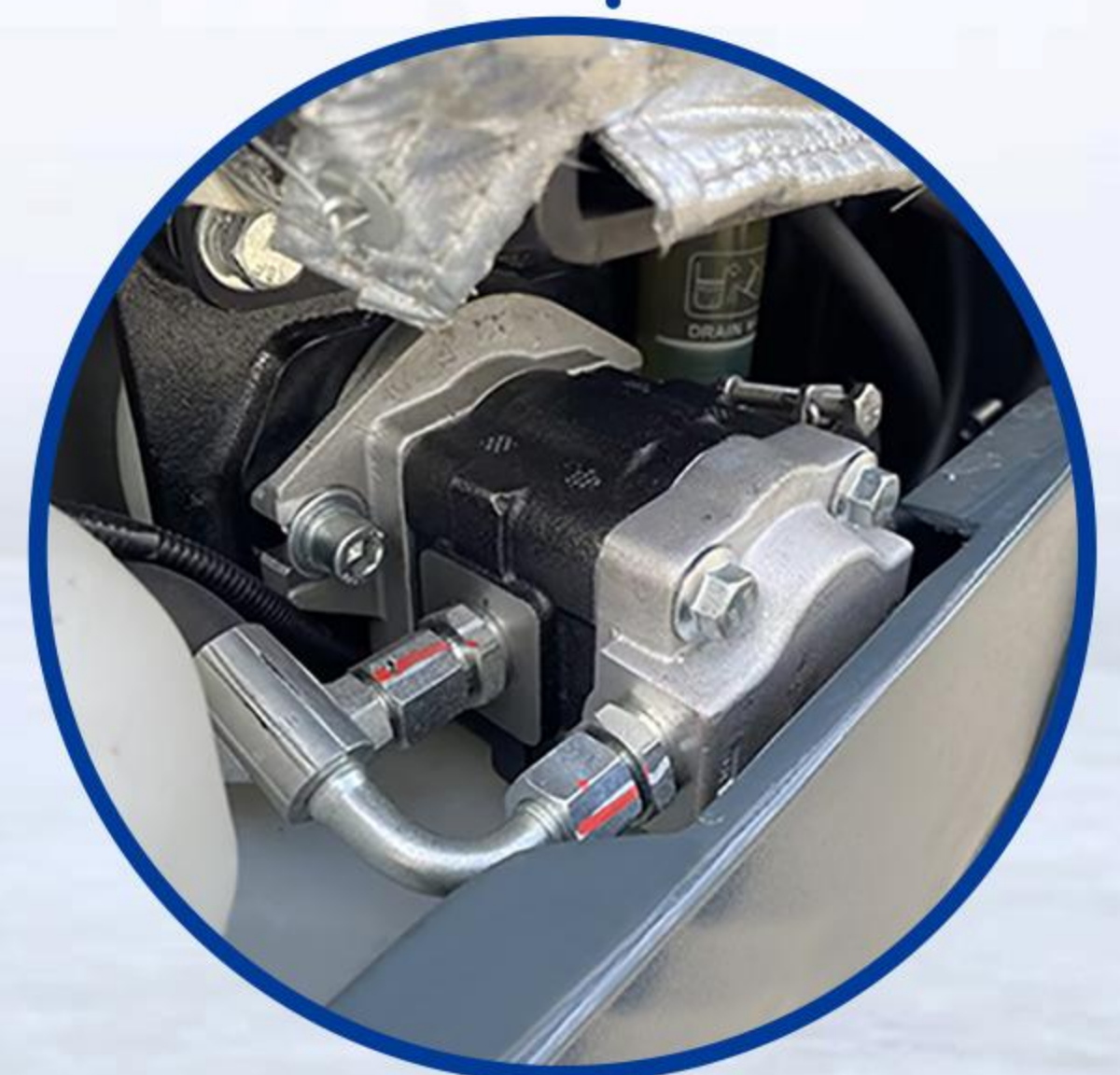
Kombinierte Konfiguration mit 3 Pumpen
