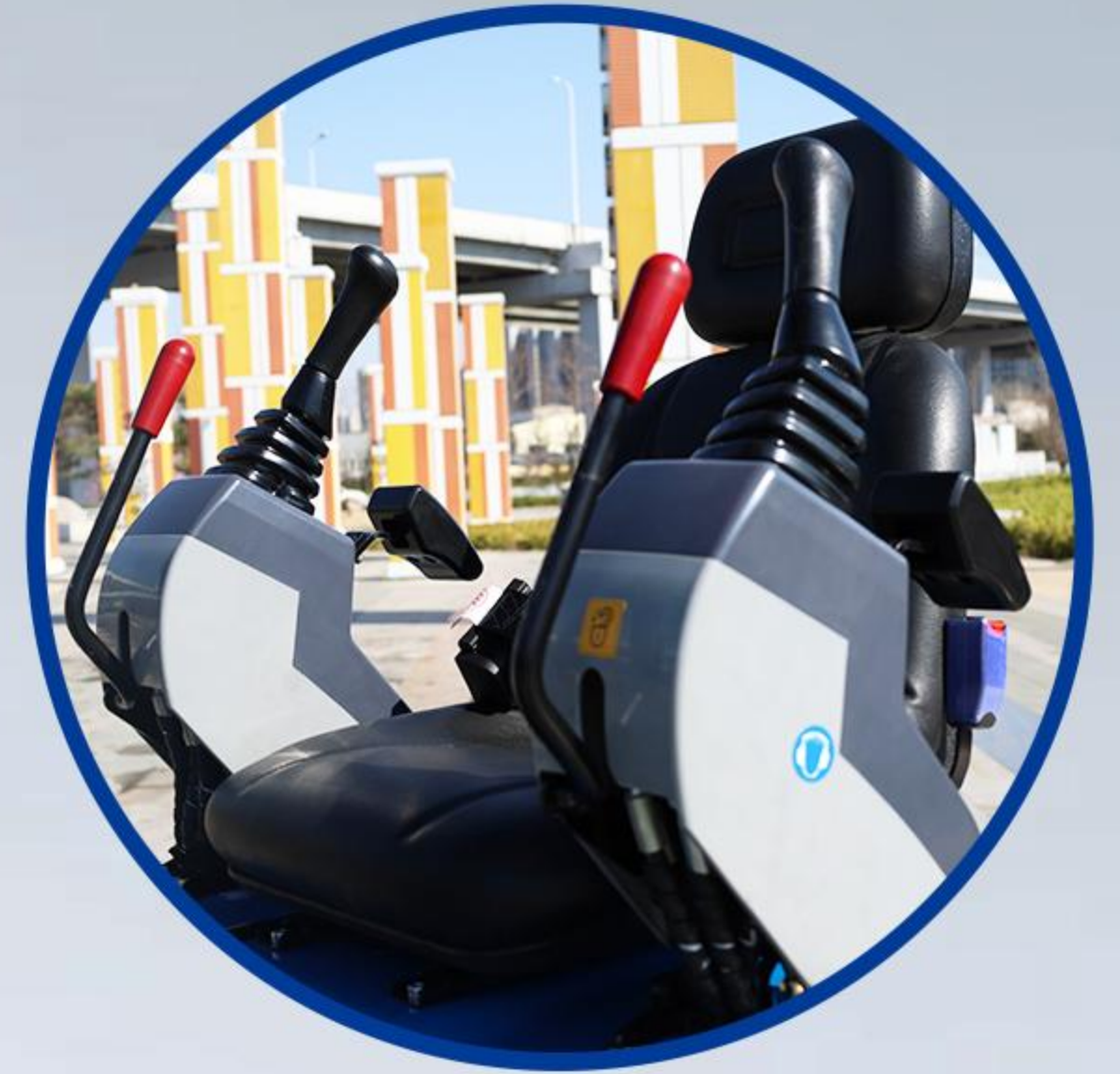
Beidseitige Armlehnenboxen mit Hebefunktion
