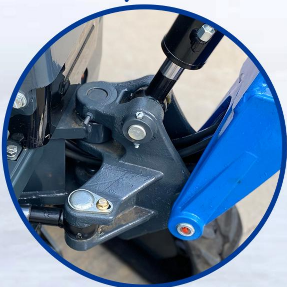
Integrierter Guss der Auslegerhalterung
