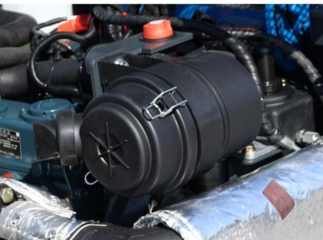
7 Filtr powietrza Zapobiega przedostawaniu się kurzu i zanieczyszczeń do układu dolotowego powietrza do silnika, wydłużając w ten sposób jego żywotność.
