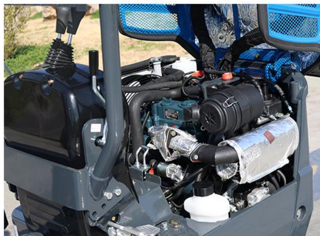
5 Całkowicie otwierana maska Całkowicie otwierana maska otwiera się szeroko do tyłu, co ułatwia codzienne przeprowadzanie przeglądów i wymianę części silnika oraz układu paliwowego.
