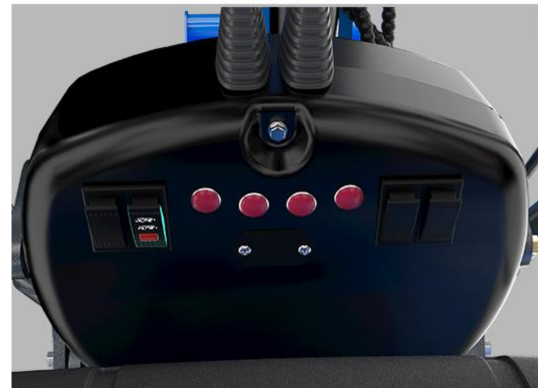
1 Levier de commande monté à l'avant Le levier de commande monté à l'avant assure un espace suffisant pour les pieds et autour du siège du conducteur.
