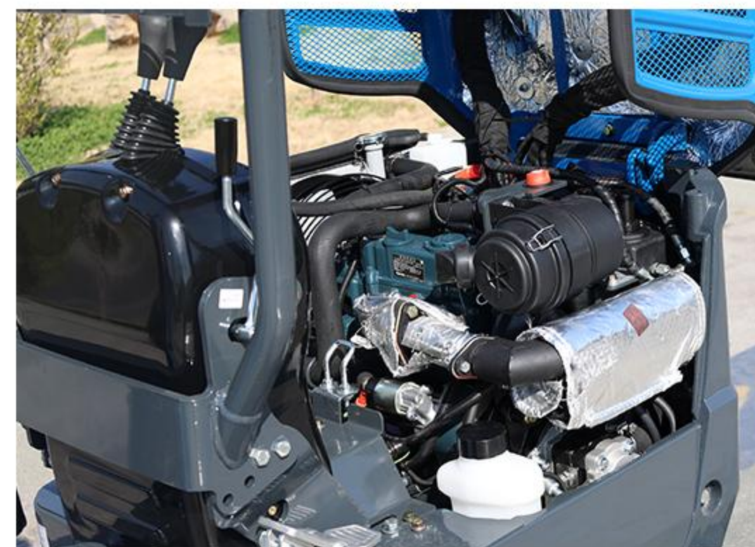
5 Capot entièrement ouvrable Le capot entièrement ouvrant s'ouvre largement vers l'arrière, ce qui facilite les inspections quotidiennes et les remplacements de pièces autour du moteur et du système de carburant.
