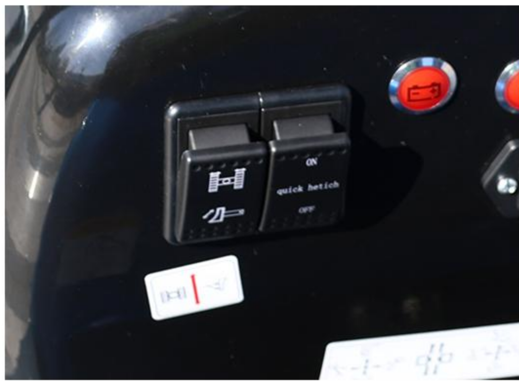
9 Bouton multifonction Les fonctions d'extension de chenille et de commutation de la lame de bulldozer peuvent être réalisées grâce à une simple opération sur un bouton, ainsi qu'au changement rapide des accessoires.
