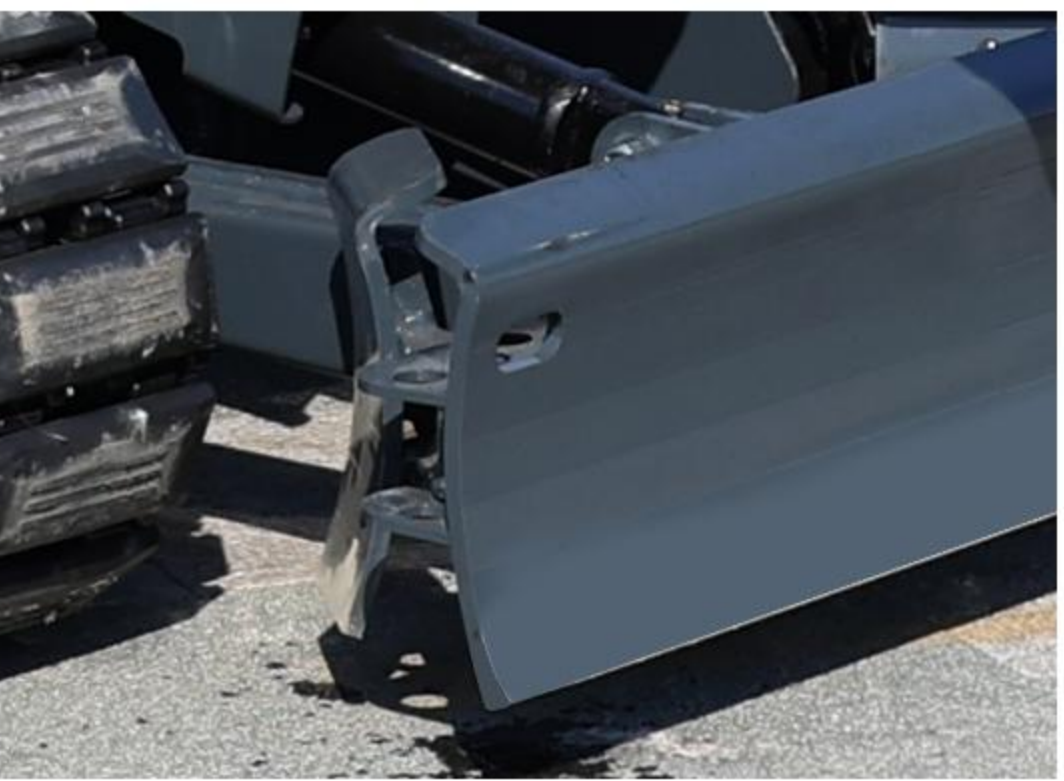
10 Lame de bulldozer allongée La largeur de la lame de bulldozer peut être facilement étendue en retirant et en fixant la goupille.
