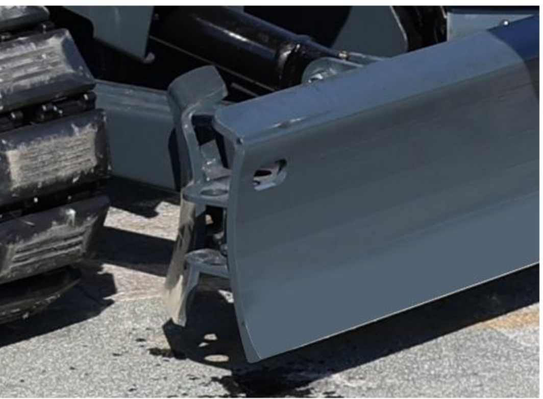
10 Erweiterte Bulldozerplatte Die Breite des Doserblatts kann durch Entfernen und Befestigen des Stiftes leicht verlängert werden.
