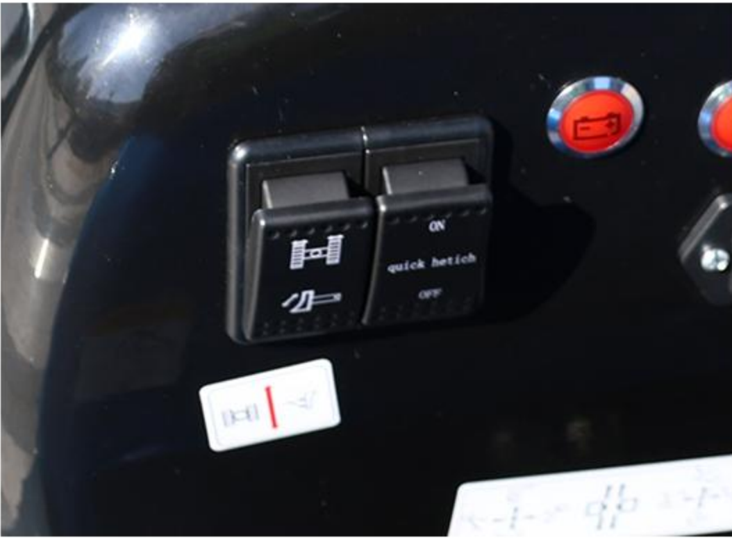
9 Többfunkciós gomb A láncot hosszabbítás és a dózerlapát váltási funkciói egyszerű gombos működtetéssel valósíthatók meg, valamint a tartozékok gyorsan cserélhetők.
