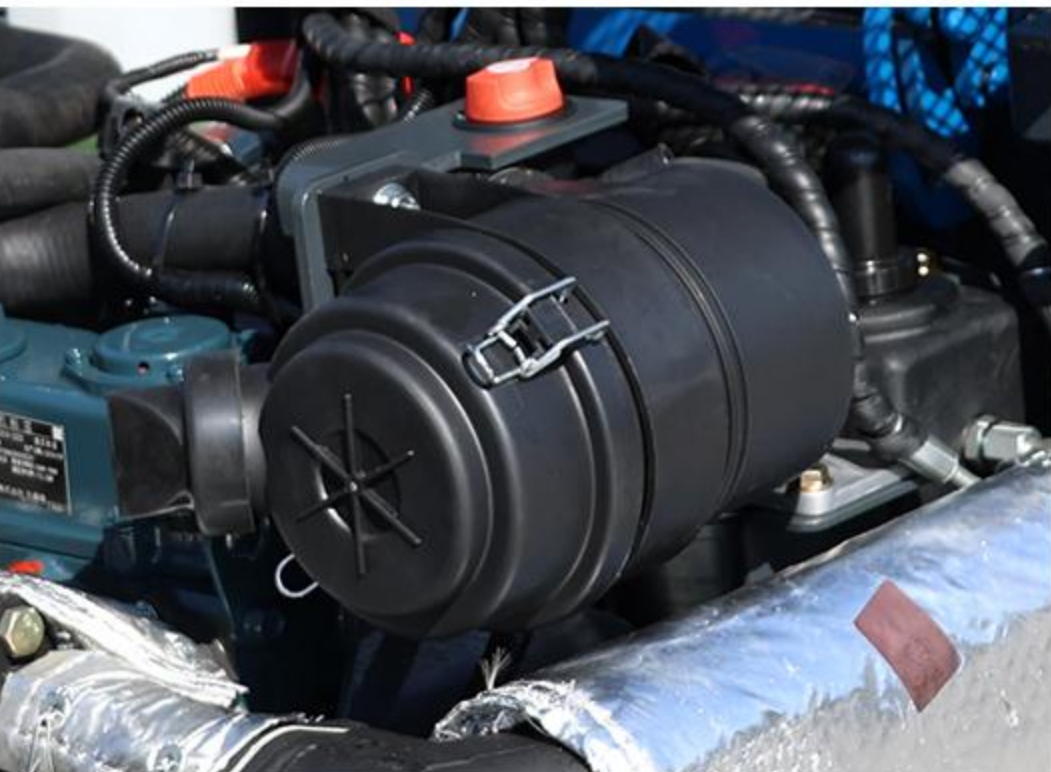
7 Légszűrő Megakadályozza a por és szennyeződések bejutását a motor levegőbeviteli rendszerébe, ezáltal meghosszabbítja a motor élettartamát
