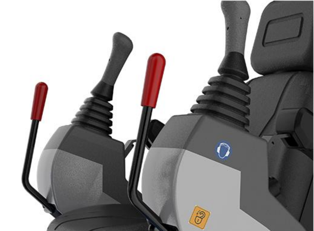
2 Működési rögzítőkar Motor üresjáratú indítási funkcióval van felszerelve, amely megakadályozza a motor beindulását, ha csak a működési reteszelő kar nincs felemelt helyzetben.
