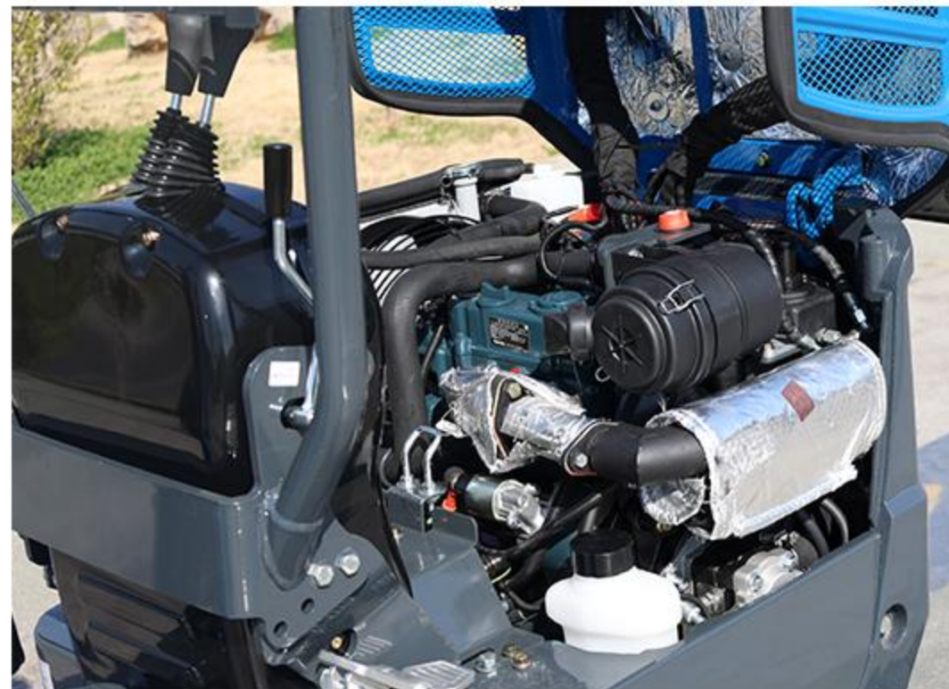
5 Teljesen nyitható motorháztető A teljesen nyitható motorháztető hátrafelé szélesre nyílik, így könnyen elvégezhetők a napi ellenőrzések és az alkatrészcsere a motor és az üzemanyagrendszer körül.
