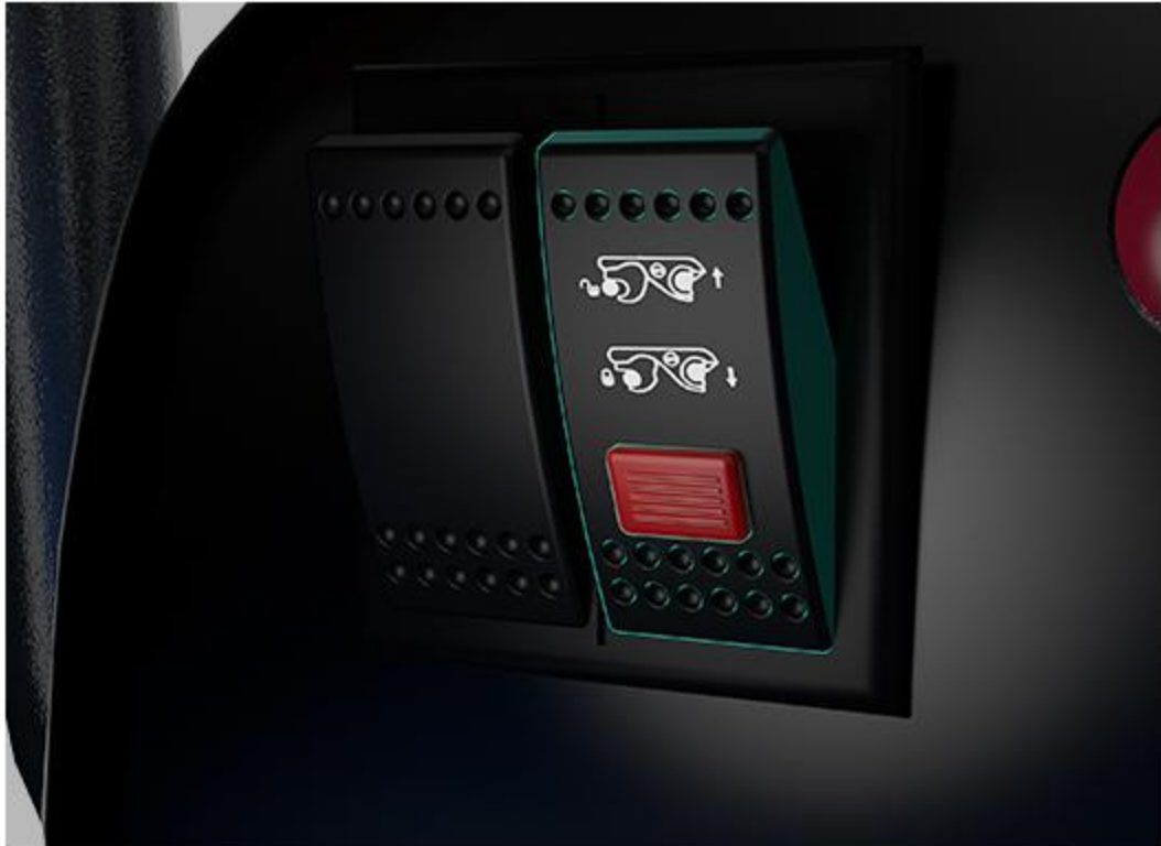
4 Dupla biztosítási billenőkapcsoló A hidraulikus gyorsváltó billenőkapcsoló mechanikus kettős védelmet biztosít a véletlen érintés megakadályozása érdekében működés közben, ami biztonságosabb.
