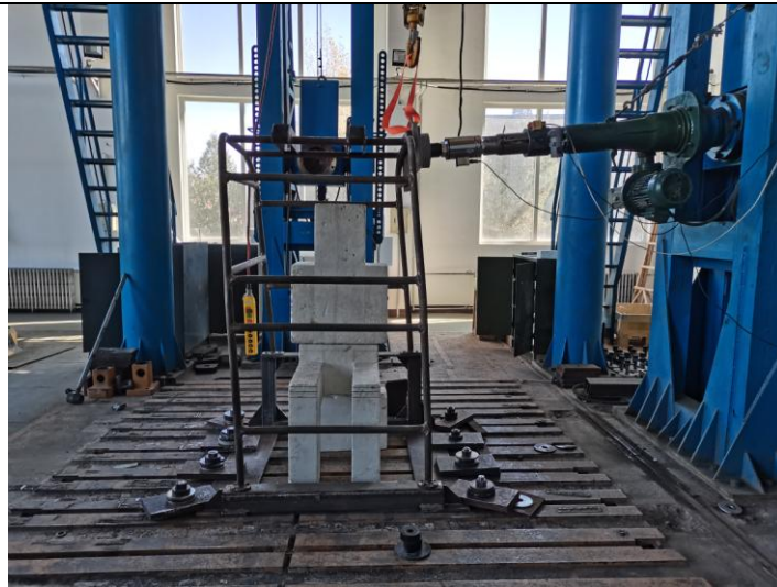
照片 F2 倾翻保护结构侧向加载试验后
