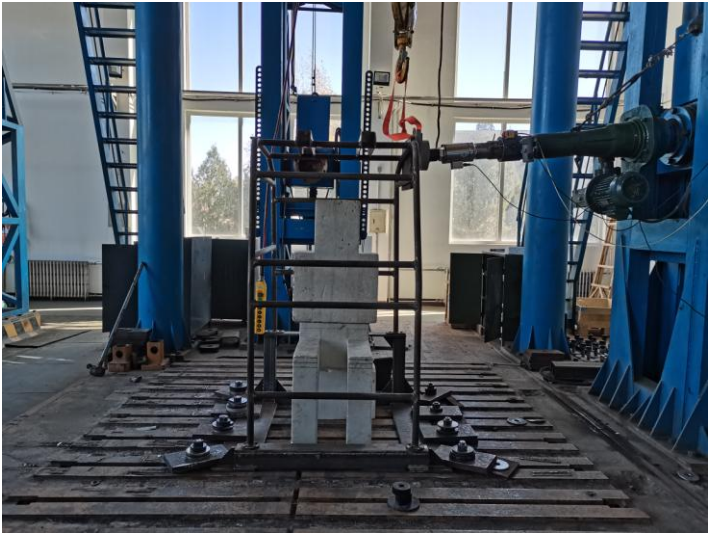
照片 F1 倾翻保护结构侧向加载试验前
